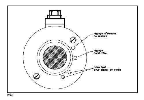
L'appareil de mesure doit avoir été utilisé au moins deux heures avant que le calibrage des capteurs de gaz ne puisse être effectué. Afin de garantir une signalisation en bonne et due forme.
