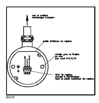
Câbles de signaux de mesure rigides menant au système électronique d'analyse.
