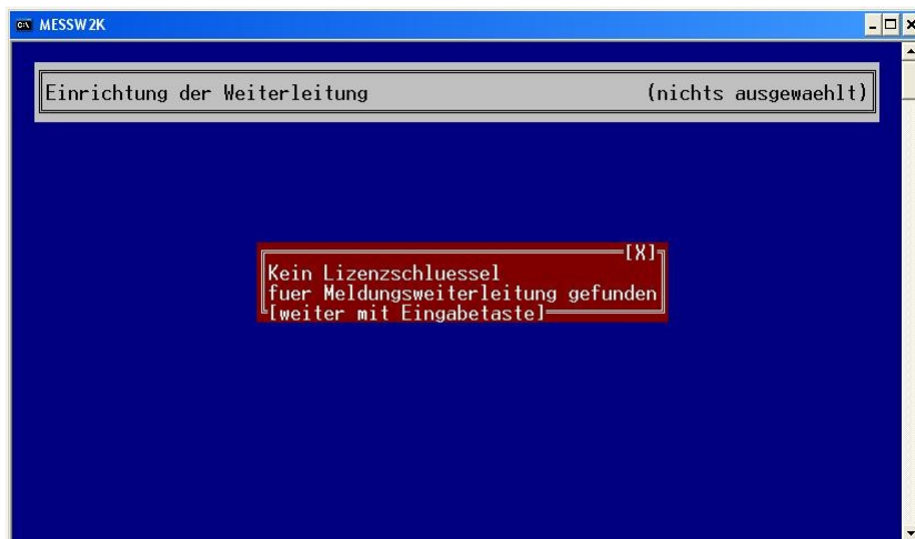
Abb.: Dongle fehlt; Einrichtung der Störungweiterleitung ist möglich
