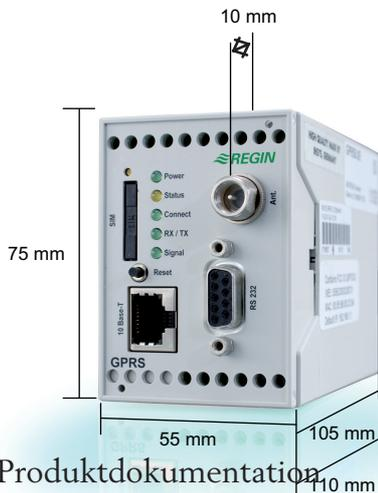
Ein Schaltschrank sollte eine Tiefe von min 155 mm haben, damit die Antenne installiert werden kann, ohne das Kabel zu sehr zu knicken.
