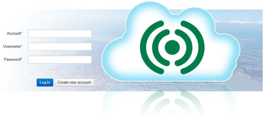
Il est possible de connecter un Corrigo/Exigo avec serveur web intégré à CLOUDigo, un service informatique basé sur le cloud qui permet de superviser facilement un Corrigo/Exigo via Internet.
