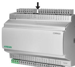
Con questo tipo di montaggio, il cavo deve essere fatto passare attraverso l'alternativa uscita nella parte inferiore del contenitore (vedere la figura sotto). Sollevare il coperchio e spostare il cavo. Ruotare il coperchio di 180 °, bloccando l'uscita laterale. Quindi rimontare il coperchio.
