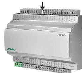
I detta fall är det lämpligt att leda ut kabeln genom det alternativa utloppshålet i nederkanten av kopplingsutrymmet (se nedanstående figur). Bänd loss locket och flytta kabeln. Vrid locket ett halvt varv så att sidohålet blockeras och montera tillbaka locket.
