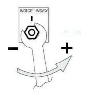
L'étalonnage du thermostat peut être ajusté en tournant l'écrou hexagonal se trouvant sous le bouton du point de consigne
