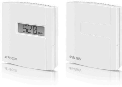
Eine Baureihe von Raumtransmittern zur Messung der Kohlendioxidkonzentration in Innenräumen. Der Transmitter hat einen integrierten CO<sub>2</sub>-Sensor mit Ausgangssignal 0...10 V, einen PT1000-Sensor mit separaten Klemmen, sowie ein Ausgangssignal für die relative Luftfeuchte.
