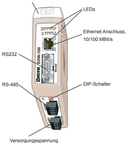
Der ConverterTCP kann auf eine DIN-Schiene montiert werden und verfügt über zwei Kommunikationsschnittstellen: eine RS-485- und eine TCP/IP-Schnittstelle.
