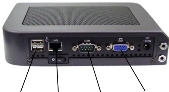
2 USB Schnittstellen    LAN Schnittstelle    RS232 Schnittstelle (COM1)    Bildschirmanschluss
